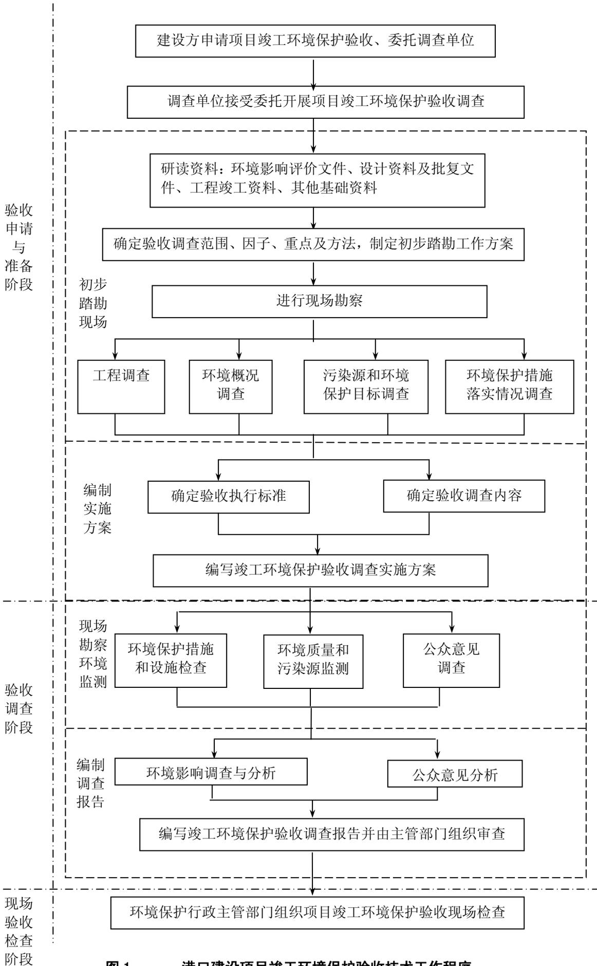
图 1 港口建设项目竣工环境保护验收技术工作程序
